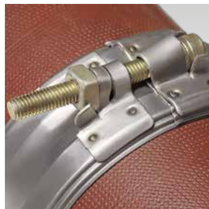
Szemrevételezés: A lefolyócső-csatlakozó meghúzása után: az ellenőrző rés zárva van
